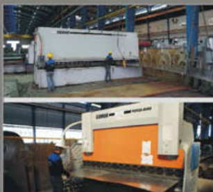
گیوتین برش CNC عرض 6 متر و پرس برگ CNC CNC guillotine cutting machine, width 6 meters and CNC brake press-300Ton
